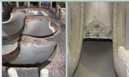
A gödrösödés és az erózió egyértelműen látható
